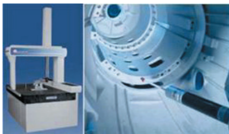
Slika 3.: CMM skener i kontaktno pipalo
